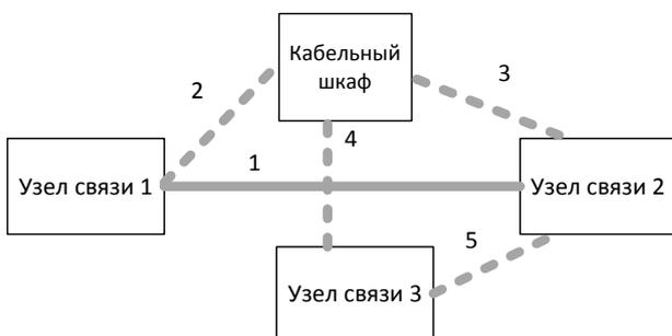
Рисунок 3. Связь между узлами 1 и 2 может быть организована по кабелям: 1; 2-3; 2-4-5.
