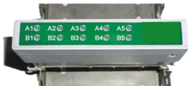
Рисунок 1.6 Кроссовый переключатель Commeng LSW S5 , установленный в плинт.
